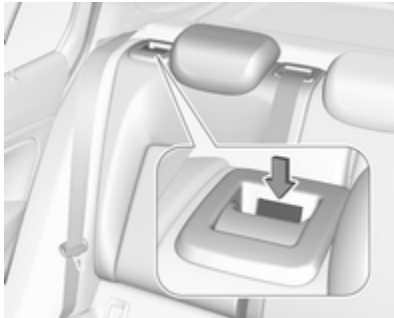
Oparcia są prawidłowo zablokowane, gdy czerwone
